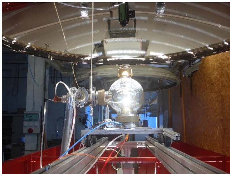
Figure 1 : Photo du réacteur de pyrolyse solaire et de la parabole
