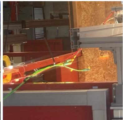
(f) Fixation des câbles des thermocouples.
