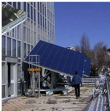
FIGURE 4.7 – Héliostats des fours de 850 W, 1500 W et 6000 W.
