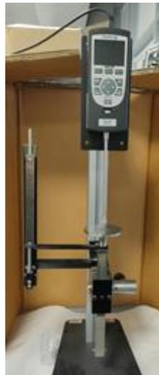
Figure 5. **Dynamometer Ametek Chatillon DFS II-100**
